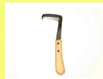
削蹄鎌 (さくていがま) (「野鍛冶のワークツール」にて展示)
